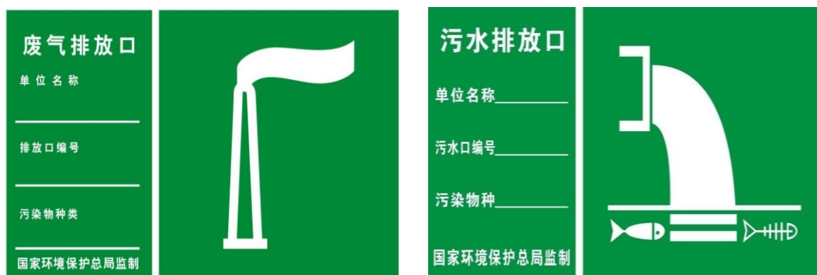
图 8.2-1 规范化废气及废水排放口标志牌
