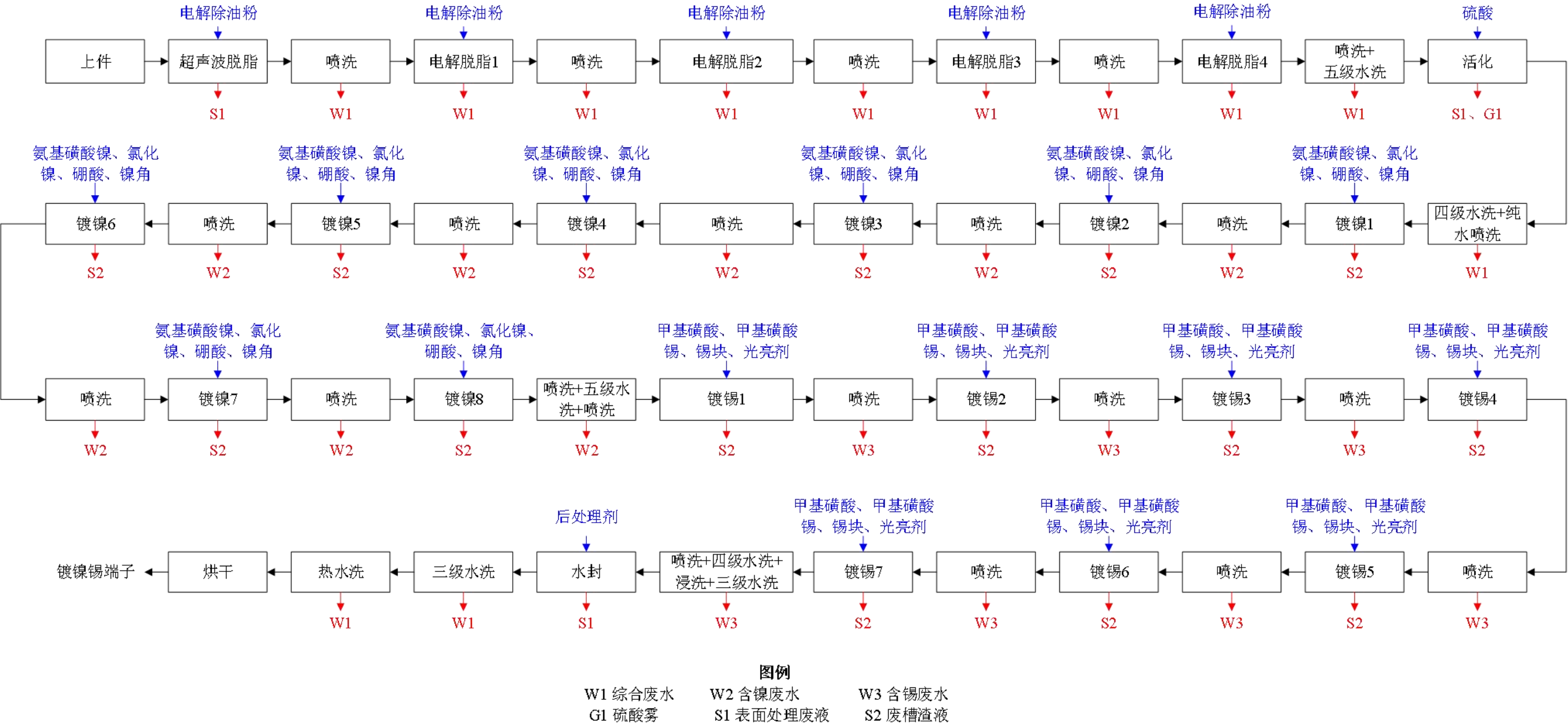
图 3.5-5 端子电镀工艺流程及产污节点图
