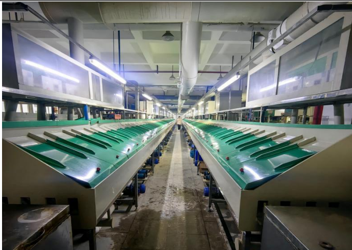
图 7.1-2 类似项目单层密闭负压收集废气示意图
