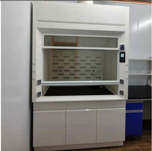
图 7.1-3 类似项目半密闭型集气设备收集废气示意图
