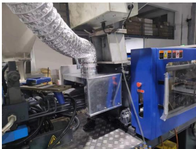
图 7.1-1 类似项目包围式集气罩收集废气示意图
