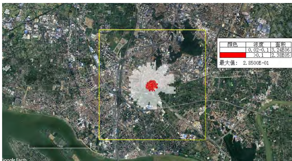
图 5.5-26 正常工况下非甲烷总烃 1 小时平均质量浓度分布图
