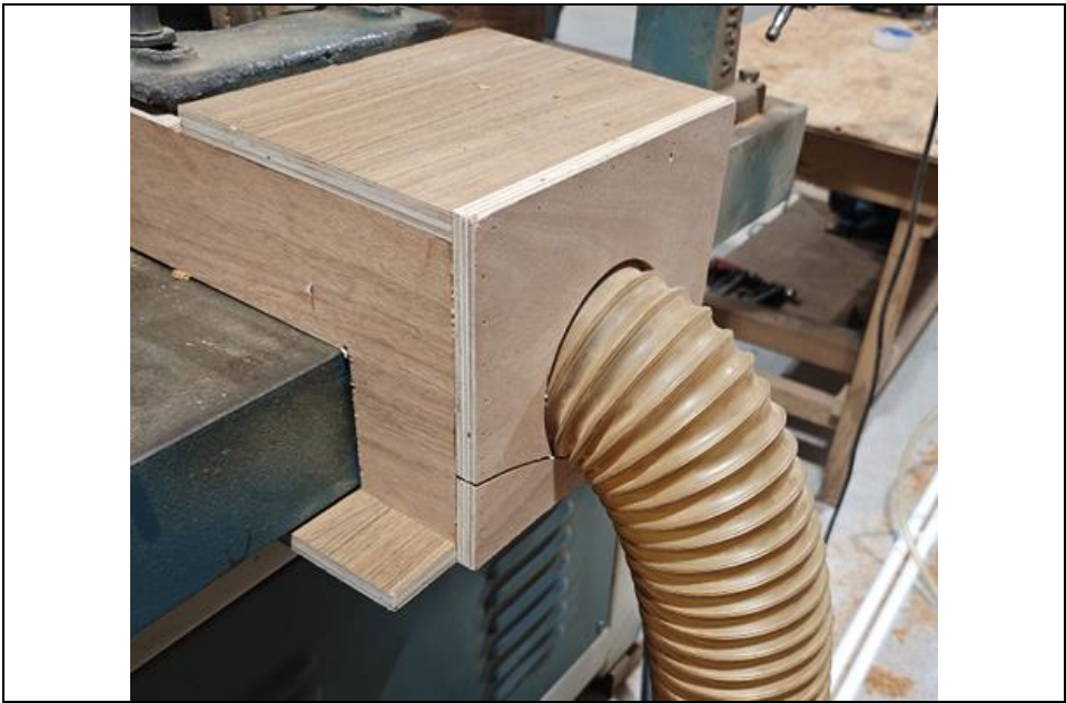
图 3.6-3 项目木加工废气收集方式示意图
