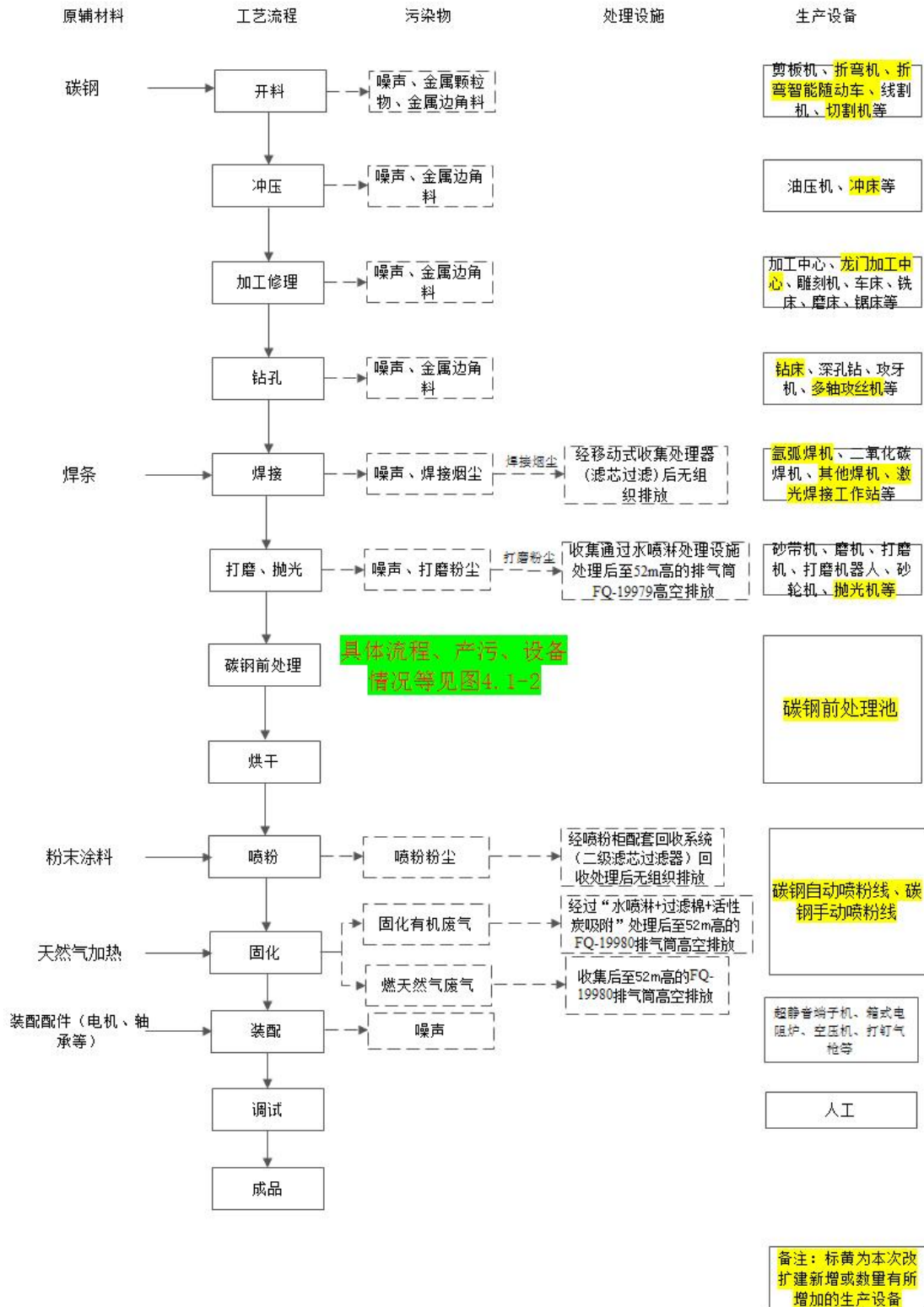
图 4.1-1 碳钢加工生产工艺总流程图
